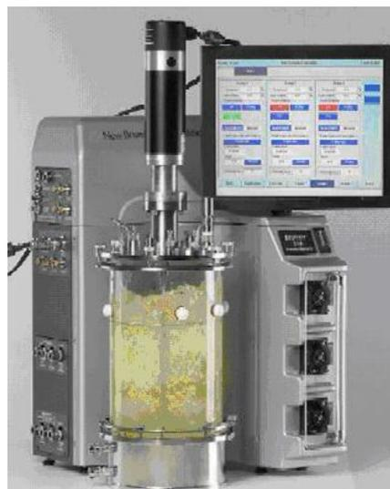
バイオリアクターでは、容量14Lのジャーを用いてインペラーで攪拌しながら培養を行います。二酸化炭素濃度、酸素濃度（5～95%）、水温（10～80℃）、pH（2～12）、光強度（0～10,000  $\mu\text{E}/\text{m}^2/\text{sec}$ ）の設定が可能です。バッファー、炭素源、泡消材等をポンプにより培養中に投入することができます。また、空気、酸素、二酸化炭素、窒素など4種類のガスを通気することができます。15インチのタッチスクリーンには、全ての設定値、現在値、ポンプ流量などが表示され、培養を直感的にナビゲーションすることができます。細胞の回収に用いる遠心機は、容量1Lのボトル6本（計6L）を1度に遠心することができます（max 7,000rpm; 11,100g; -20～40℃）。
